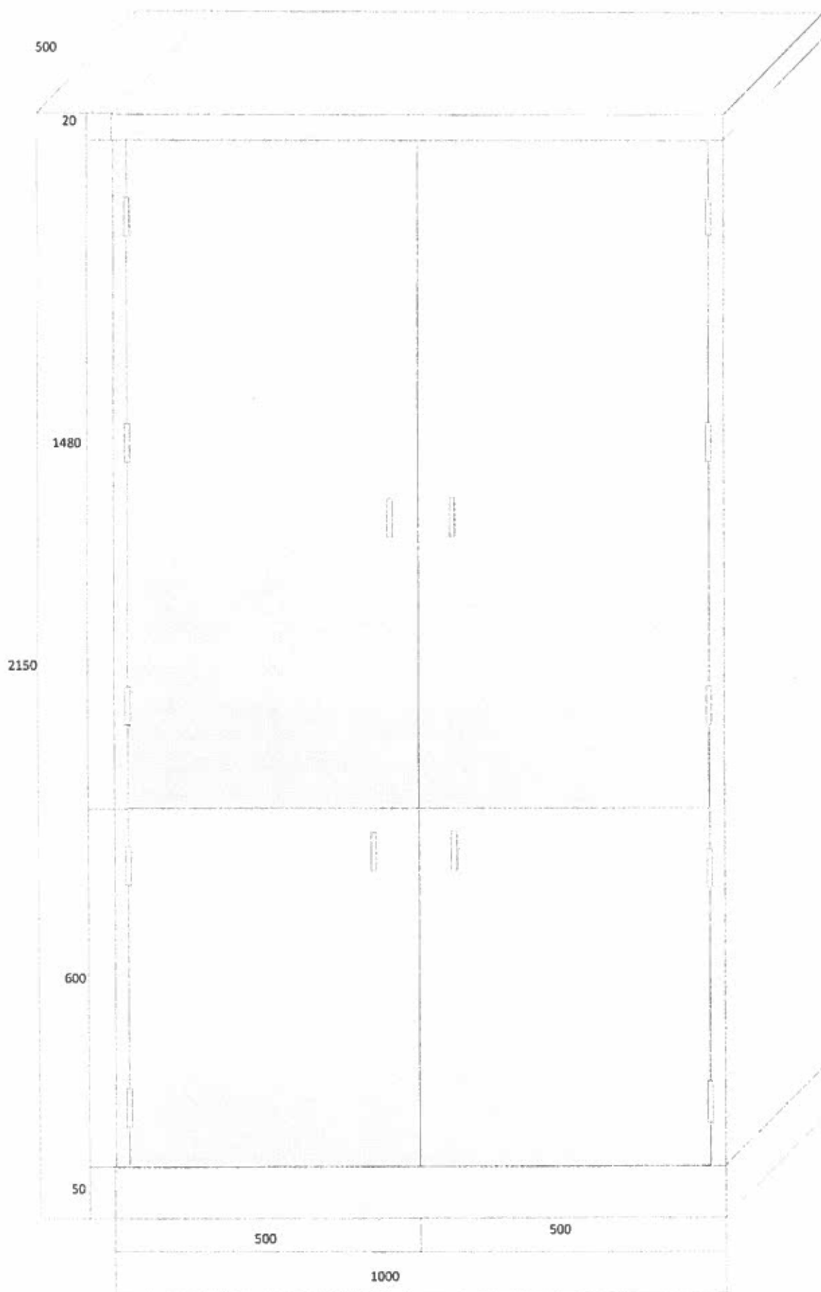
Внешний вид секции шкафа для хранения противогазов и касок
